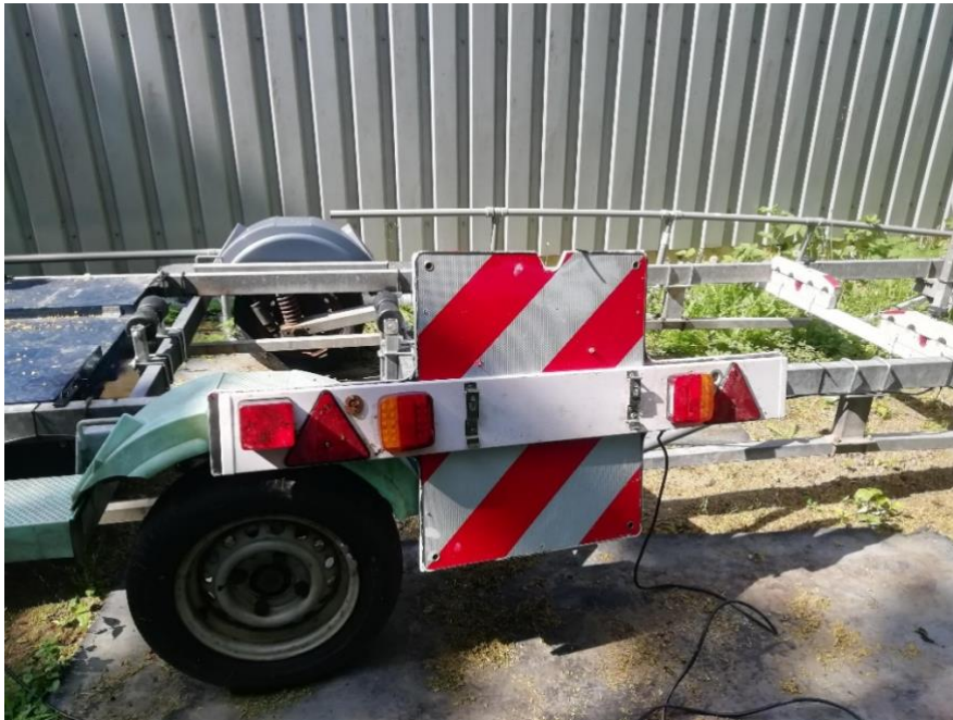
Figuur 5.2-1 Voor het achterwiel het teveel aan kabel om het waarschuwingsbord wikkelen
