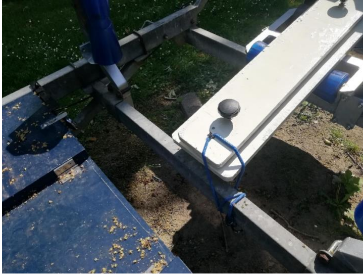
Figuur 5.3-3 Met elastiek vastmaken en teveel aan kabel om kentekenbalk wikkelen
