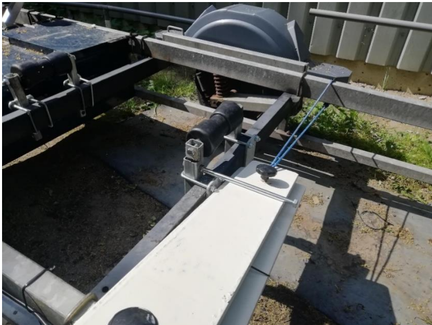
Figuur 5.2-2 Eerst onder stalen pen bij kielblok door en dan met elastiek vastzetten
