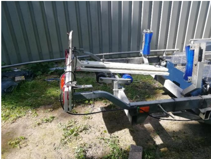
Figuur 5.3-2 Zijaanzicht goed vast maken onder RVS klemmen
